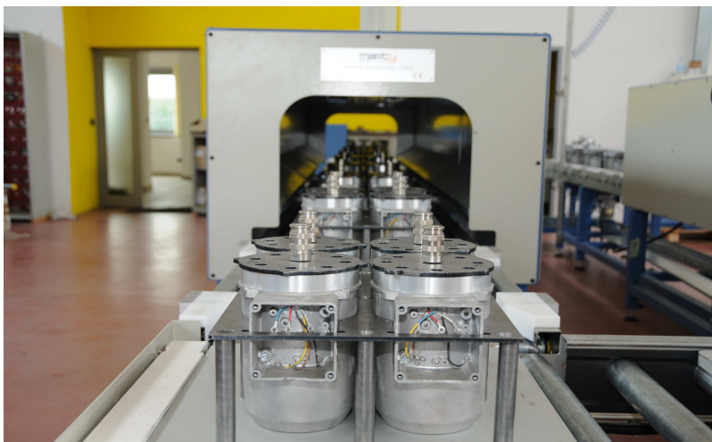
Tunnelofen: Durch Infrarotlampen wird eine Vorwärmung und erste Gelierung erreicht.
